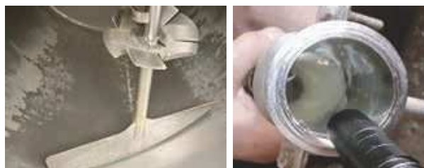
洗浄不良のバルク・ライン
