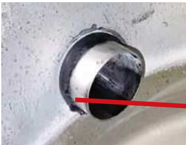
ミルクジャー内部のゴム、劣化により変形、触るとゴムが溶けている。
