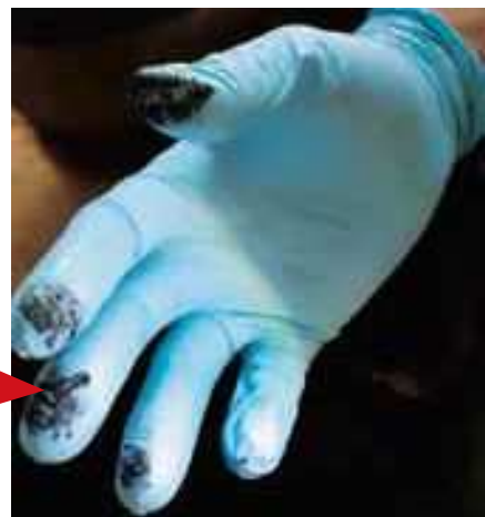
ミルクジャー内部のゴム、劣化により変形、触るとゴムが溶けている。
